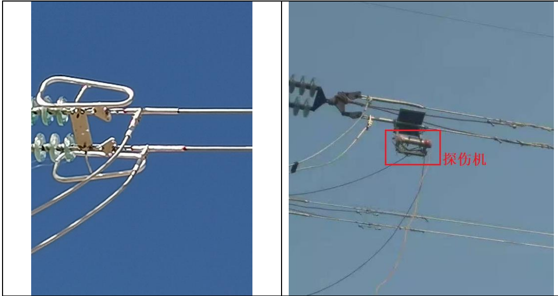
图 9-2 项目典型探伤工件及探伤机工作时照片
